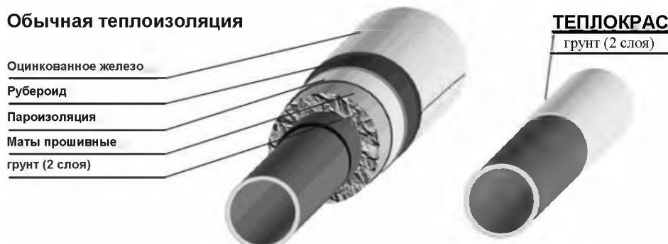
Рисунок 2.6.2 нанесение жидкой теплоизоляции «ТЕПЛОКРАС»
